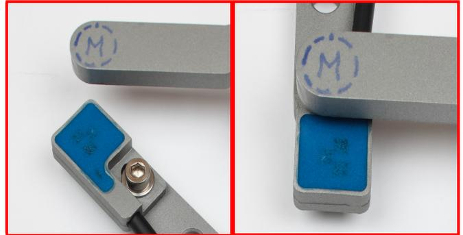
**Abbildung 43: Falsche Anordnungen** – das Sensorelement „Klaue“ sind teilweise im Eingriff“ spricht als Erstes an (links); das Sensorelement „Endanschlag“ spricht als Erstes an (rechts);
