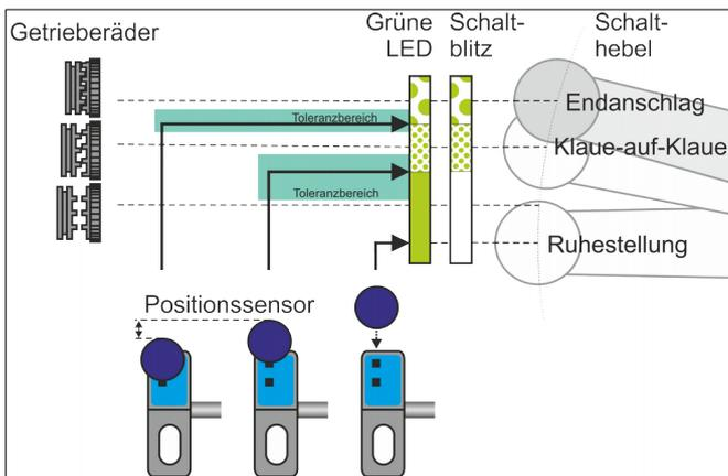
**Abbildung 33:** Positionssensorstellungen.
