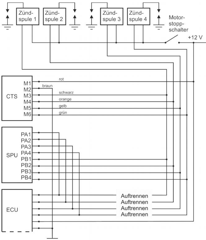
**Abbildung 12:** Prinzipieller CTS-Anschlussplan für Suzuki mit Power Unit.
