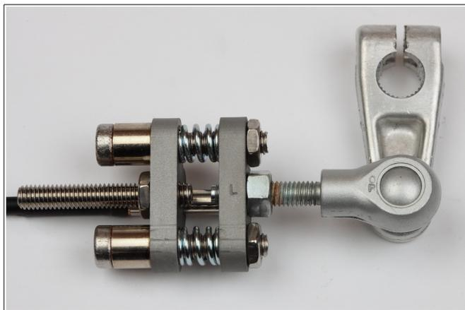
**Abbildung 31:** Magnetplatte mit M6-Linksgewinde.
