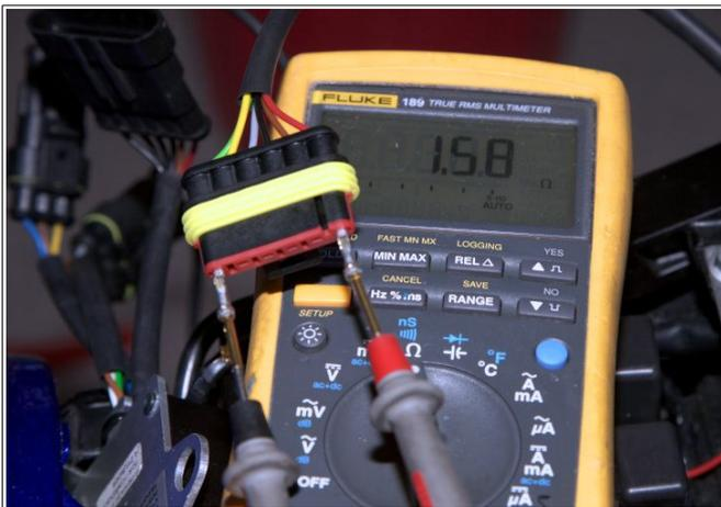
Abbildung 10: Messen des Spulenwiderstandes.
