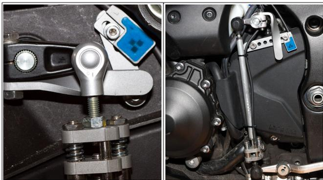
**Abbildung 40:** L-Variante des älteren Positionssensors – Honda SC59 ABS mit Normalschaltung (links); Yamaha RN22 mit Normalschaltung (rechts);
