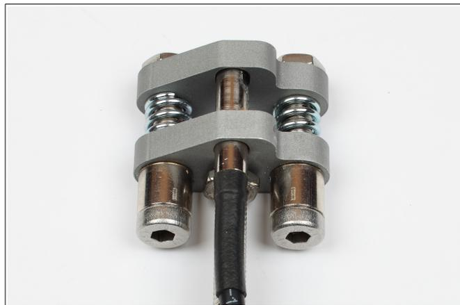
**Abbildung 19:** Der Kraftsensor ist als Drucksensor zusammengesetzt. Die Federn liegen zwischen den Platten.
