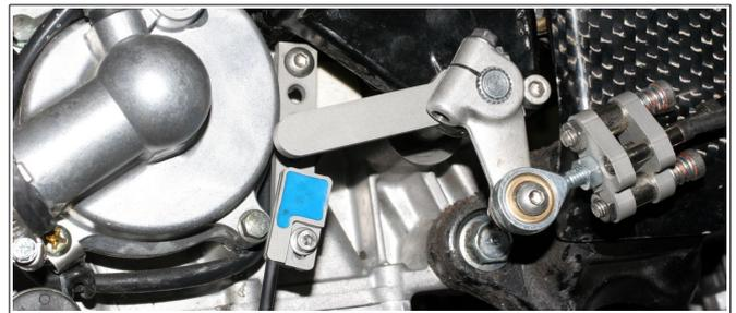
Abbildung 5: Anordnung von älterem Positionssensor und Magnethebel.
