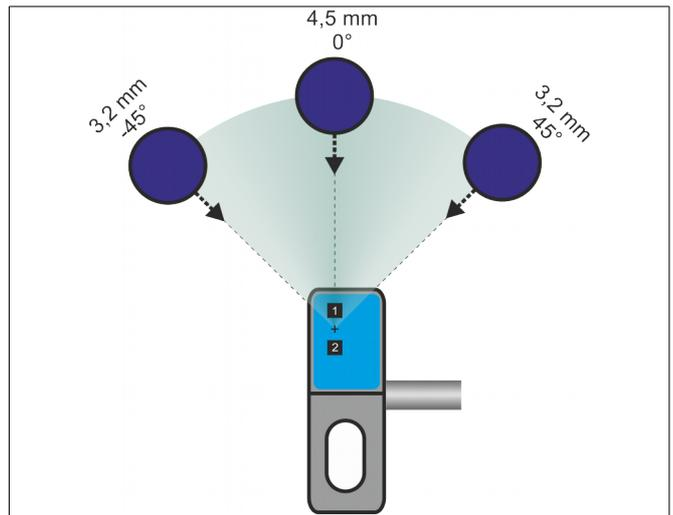
**Abbildung 34:** Anordnung von bisherigem Positionssensor und Magnethebel.
