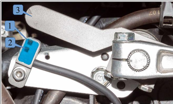
**Abbildung 32:** Honda SC59 mit bisherigem Positionssensor und Magnethebel.
