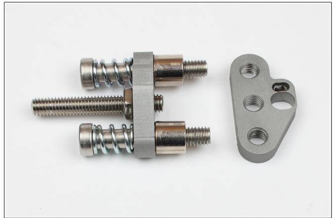
**Abbildung 25:** Dann werden die Federn auf die Schrauben geschoben.
