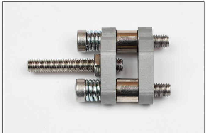
**Abbildung 26:** Anschließend wird die Magnetplatte angeschraubt, wobei die Schrauben nur soweit angezogen werden, bis die Federn blockieren.
