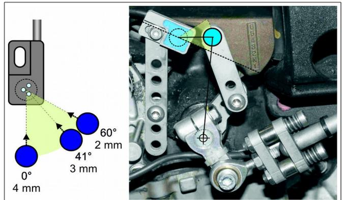
**Abbildung 38:** Anordnung von älterem Positionssensor und Magnethebel.
