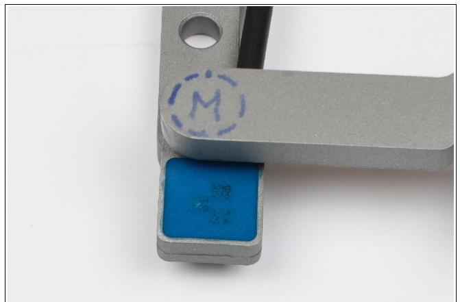
Abbildung 8: Das Sensorelement „Endanschlag“ spricht als erstes an (Fehlerhafte Anordnung).
