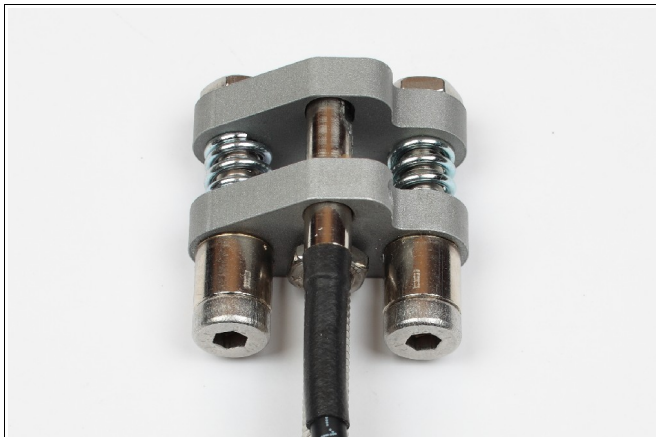
Abbildung 1: Der Kraftsensor ist als Drucksensor zusammengebaut. Die Federn liegen zwischen den Platten.
