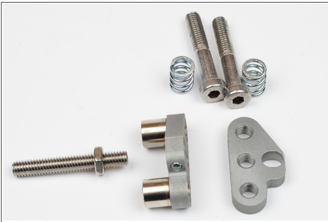
Abbildung 5: Die Inbus-Madenschraube M6x40 wird entfernt.
