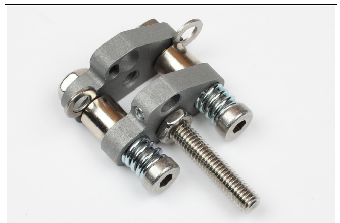
Abbildung 10: Der Sensor wird 1 mm vorgespannt. Dazu eignen sich Unterlegscheiben M5 die eine Dicke von 1 mm haben.
