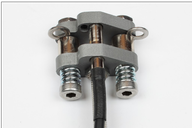
Abbildung 11: Dann wird der Hallsensor (zum Einstellen der Mindestkraft) justiert, wobei der Sensor mit etwa 1 mm vorgespannt sein sollte. Beim Erreichen der Mindestkraft leuchtet die Start LED der CTS-Box auf.
