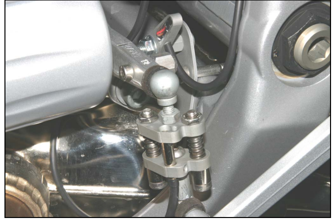
Abbildung 15: BMW R1100S mit Resetsensor und Festmagnet.
