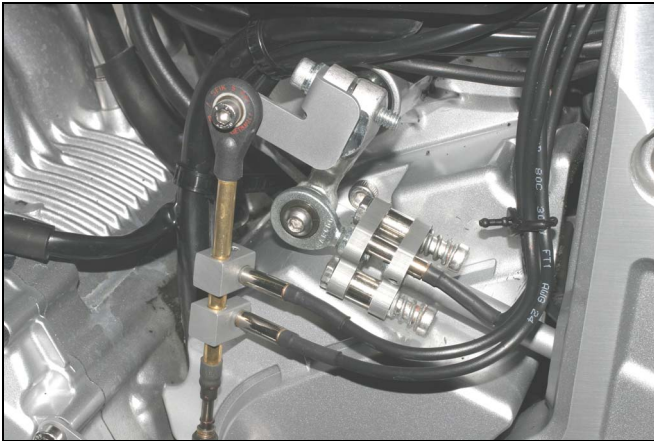
Abbildung 12: Yamaha FZS1000 mit Reset-Sensor (Versuchsausführung).
