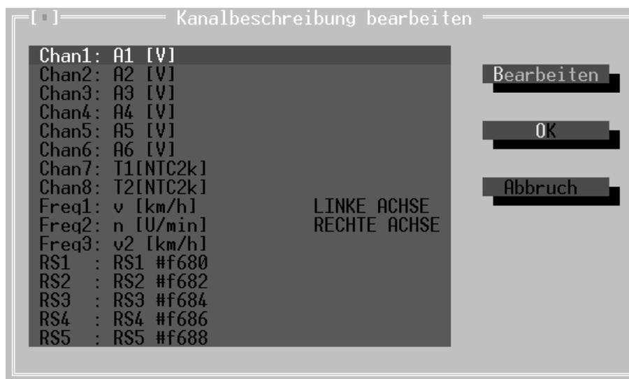
Mit der  $\downarrow$ -Taste und der  $\uparrow$ -Taste kann man den gewünschten Kanal auswählen. Mit der Tastenkombination  $\text{Strg}+\text{a}$  ändert man die Achsenzuweisung für den ausgewählten Kanal. Die Achsenzugehörigkeit wird nur beim Konvertieren ins
