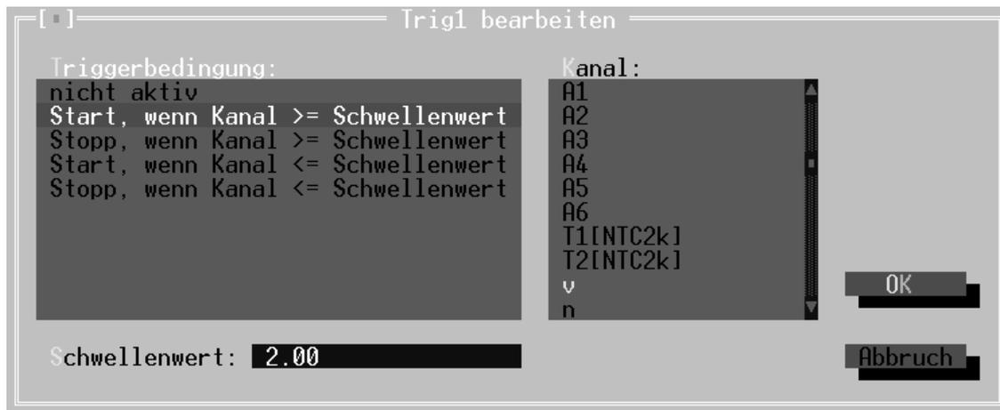
Im Feld *Triggerbedingung* wird der Operator der Triggerbedingung festgelegt. Im Feld *Kanal* wird der Kanal festgelegt, welcher auf der linken Seite des Operators steht. Und im Feld *Schwellenwert* wird der Zahlenwert eingegeben, welcher auf der rechten Seite des Operators steht.
