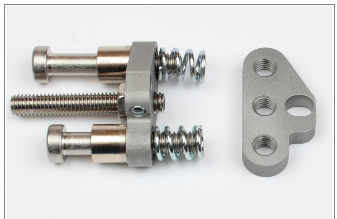
Abbildung 4: Die Schrauben werden (mit Inbus-Schlüssel SW4 oder SW5) gelöst.
