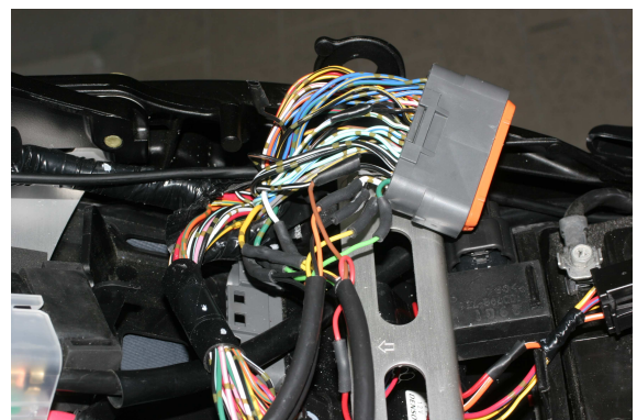
Anschluß Zündspulen und Masse bis K6
