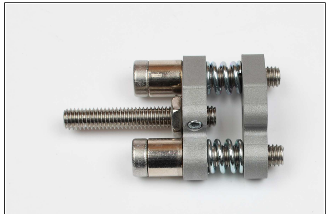
Abbildung 3: Dann werden die Kontermuttern gelöst und entfernt (SW10).
