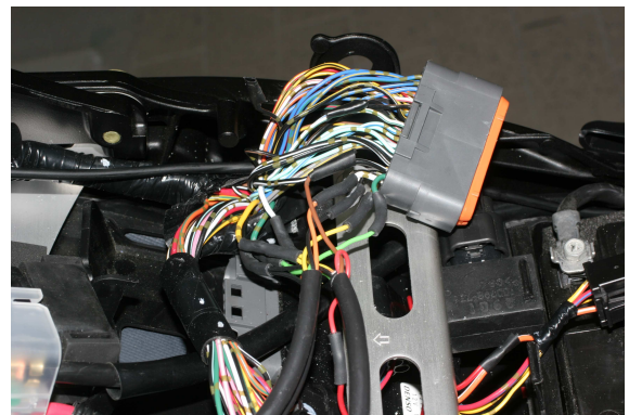
Anschluß Zündspulen und Masse bis K6
