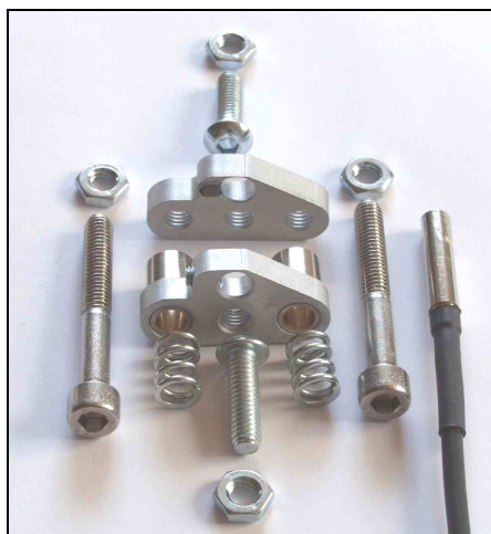
Abbildung 10: Anordnung für Zugsensor.
