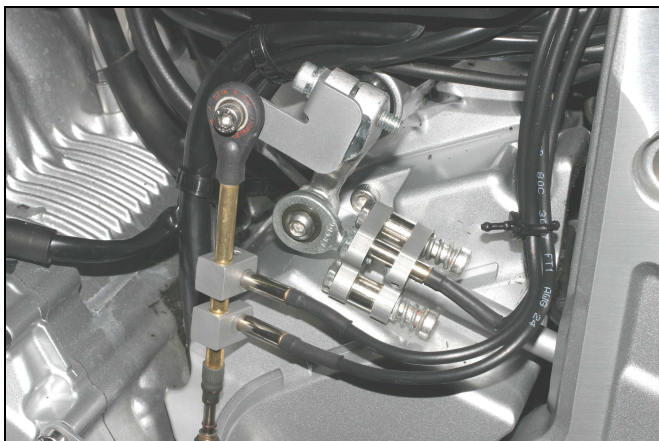
Abbildung 12: Yamaha FZS1000 mit Reset-Sensor (Versuchsausführung).
