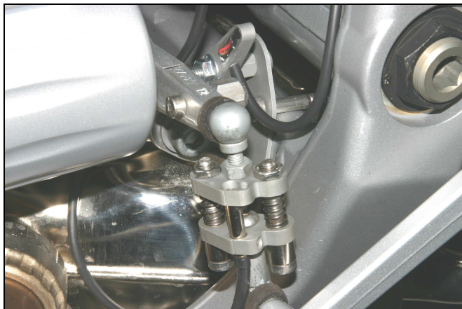
Abbildung 15: BMW R1100S mit Resetsensor und Festmagnet.
