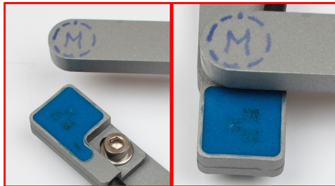
Abbildung 41: Falsche Anordnungen – das Sensorelement „Klaue sind teilweise im Eingriff“ spricht als Erstes an (links); das Sensorelement „Endanschlag“ spricht als Erstes an (rechts);
