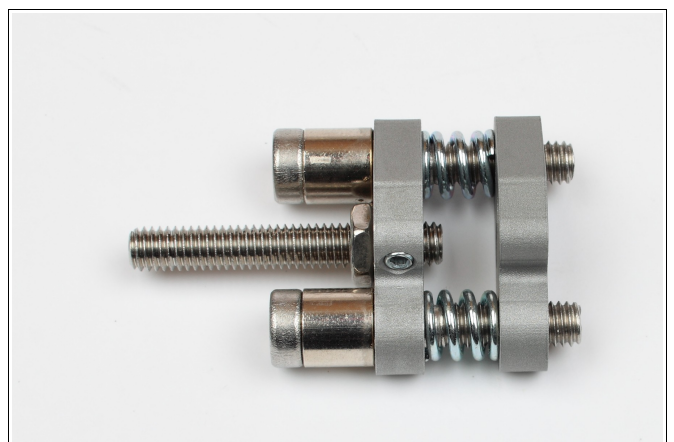
Abbildung 20: Anschließend werden die Kontermuttern gelöst und entfernt (SW10).
