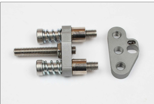
Abbildung 7: Die Federn werden auf die Schrauben geschoben.
