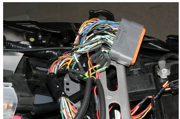
Anschluß Zündspulen und Masse bis K6
