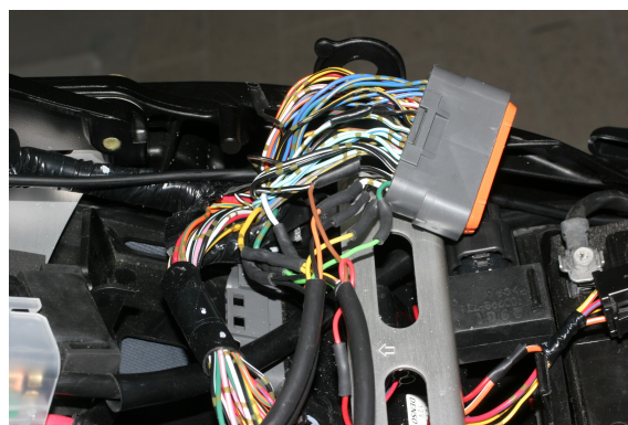
Anschluß Zündspulen und Masse bis K6
