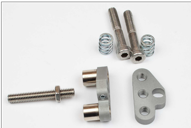
Abbildung 5: Die Inbus-Madenschraube M6x40 wird entfernt.
