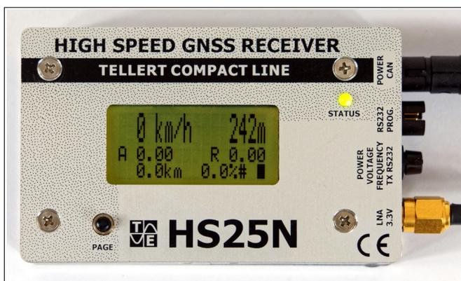
Abbildung 3: GNSS-Empfänger HS25N.
