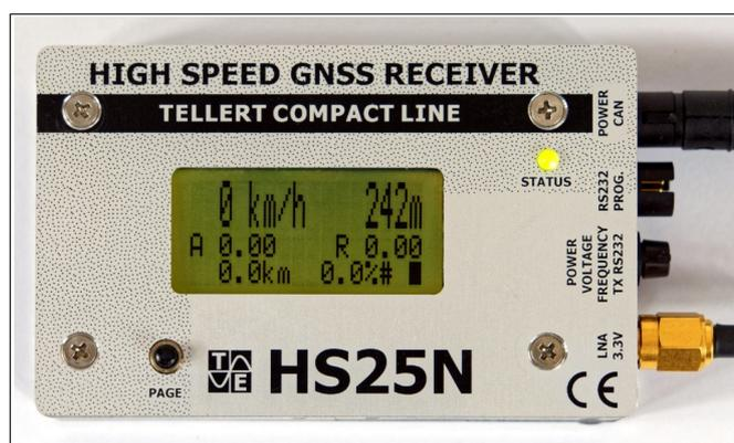
Abbildung 1: GNSS-Empfänger HS25N.
