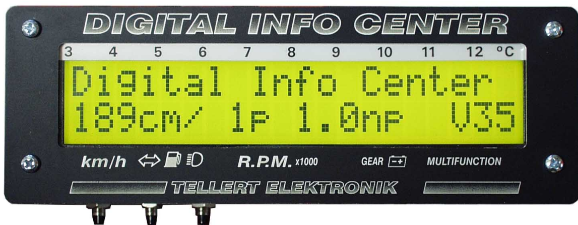
Abbildung 2: Digital Info Center Version 3.5 beim Einschalten. Es wird die Parametrierung der Geschwindigkeit (189 cm Radumfang; 1 Puls pro Radumdrehung) und die Parametrierung der Drehzahl (1 Puls pro Kurbelwellenumdrehung) angezeigt.
