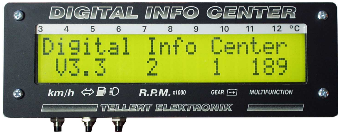
Abbildung 3: Digital Info Center Version 3.3 beim Einschalten. Es wird die Parametrierung des Vorteilers für die Motordrehzahl (2 für 360^\circ = 720^\circ / 2 ) und die Parametrierung der Geschwindigkeit (Anzahl der v-Pulse = 1; Radumfang = 189 cm) angezeigt.
