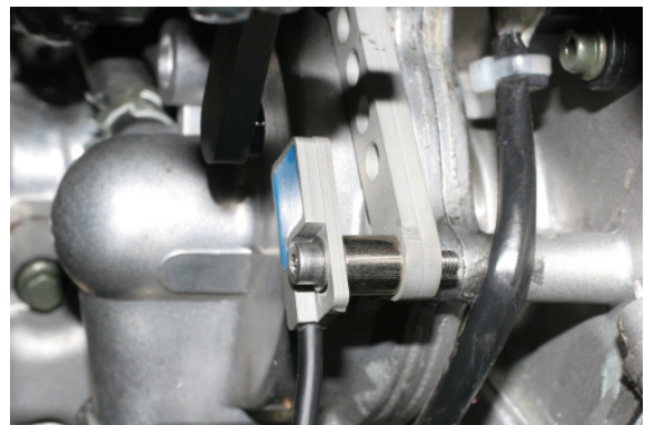
Positionssensor Montage
