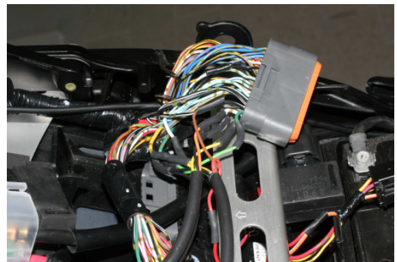
Anschluß Zündspulen und Masse bis K6
