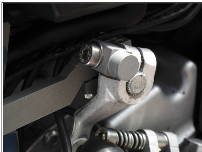
Abbildung 2: Adapter für den Magnethebel, wenn der Platz für eine Direktanbringung des Magnethebels an der Schaltwelle fehlen sollte.
