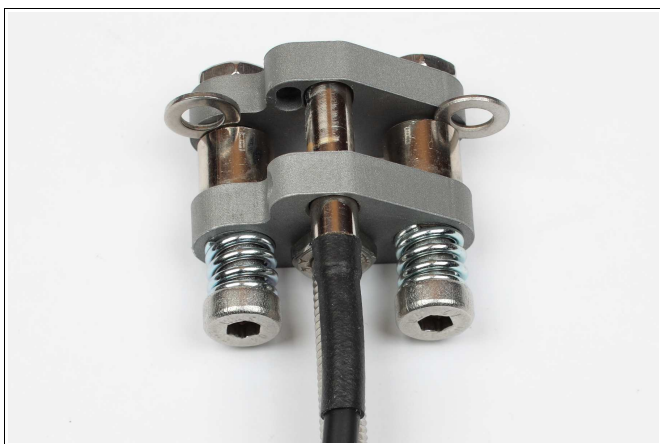
Abbildung 28: Anschließend wird der Hallsensor (zum Einstellen der Mindestkraft) justiert, wobei der Sensor mit etwa 1 mm vorgespannt sein sollte. Beim Erreichen der Mindestkraft leuchtet die Force (bzw. Start ) LED der CTS-Box auf.
