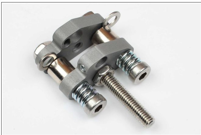
Abbildung 27: Der Sensor wird 1 mm vorgespannt. Dazu eignen sich Unterlegscheiben M5 die eine Dicke von 1 mm haben.
