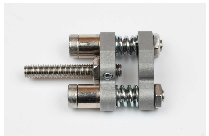
Abbildung 19: Zunächst wird der Hallsensor (mit Inbus-Schlüssel SW2) entfernt.
