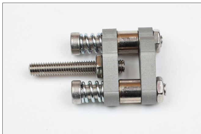
Abbildung 26: Die Schrauben werden mit 3 Umdrehungen gelöst (M6 hat eine Steigung von 1 mm), und dann in dieser Stellung mit den Kontermuttern gesichert.
