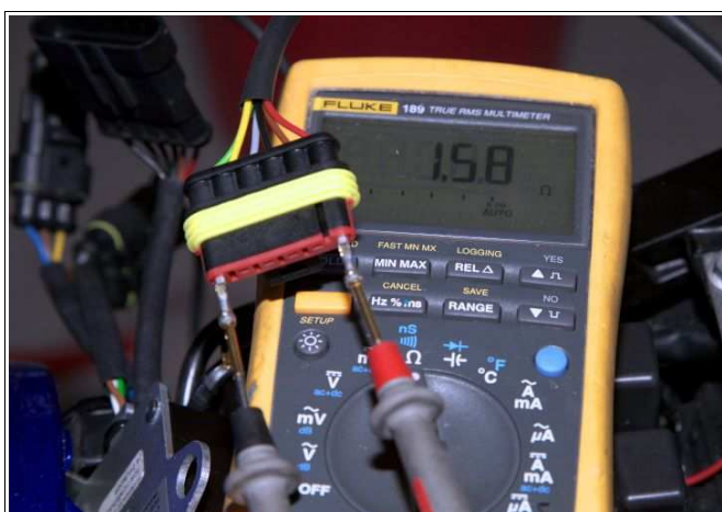
Abbildung 10: Messen des Spulenwiderstandes.
