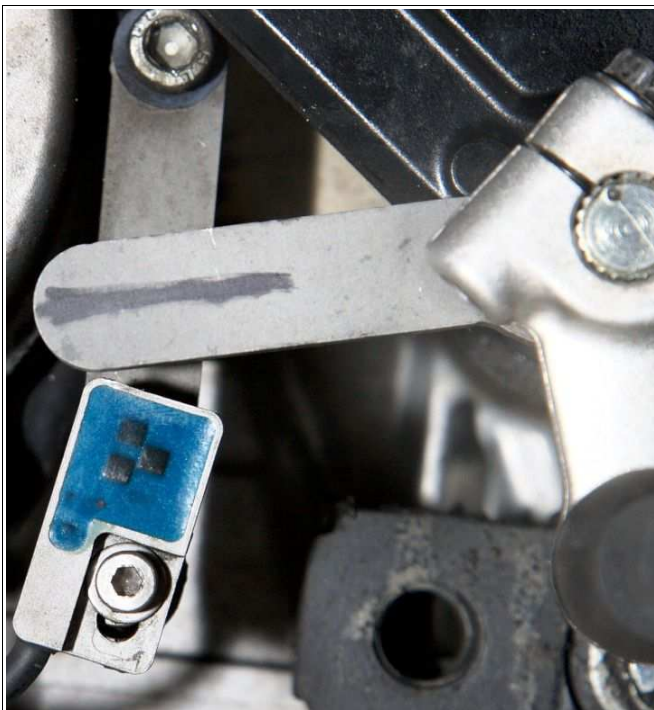
Abbildung 4: Positionssensor in Ruhestellung.
