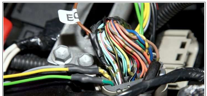
Abbildung 9: CTS-Anbindung am ECU-Anschluss 3/3.
