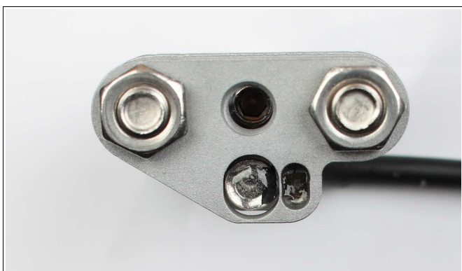
Abbildung 29: Hierbei ist zu beachten, dass das schwarze Hallsensorelement dem Magneten gegenüberliegt. Das Hallsensorelement ist das schwarze Teil in der vernickelten Sensorhülse. Der Magnet ist in der Magnetplatte eingeklebt.
