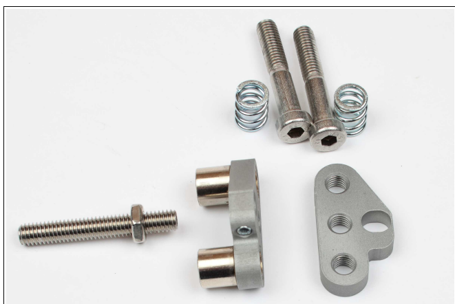
Abbildung 22: Anschließend wird die Inbus-Madenschraube M6x40 entfernt.
