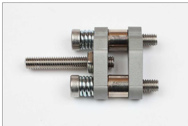
Abbildung 25: Anschließend wird die Magnetplatte angeschraubt, wobei die Schrauben nur soweit angezogen werden, bis die Federn blockieren.
