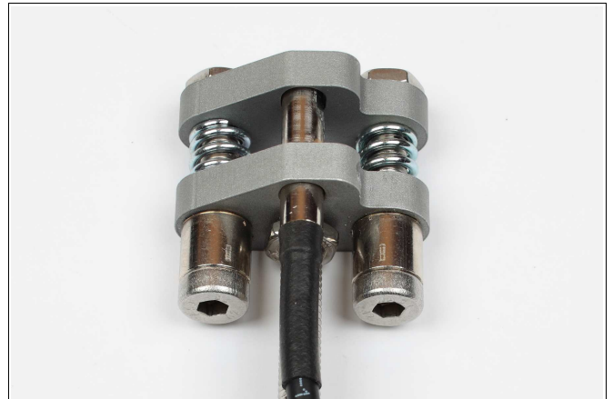
Abbildung 18: Der Kraftsensor ist als Drucksensor zusammengebaut. Die Federn liegen zwischen den Platten.
