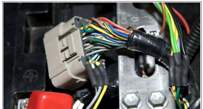
Abbildung 7: CTS-Anbindung am ECU-Anschluss 1/3.
