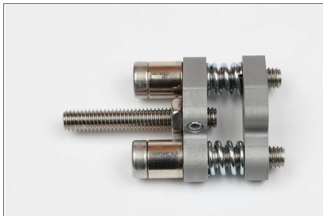
Abbildung 3: Dann werden die Kontermuttern gelöst und entfernt (SW10).
