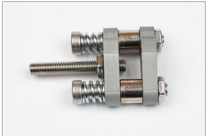
Abbildung 9: Die Schrauben werden mit 3 Umdrehungen gelöst (M6 hat eine Steigung von 1 mm) und anschließend in dieser Stellung mit den Kontermuttern gesichert.
