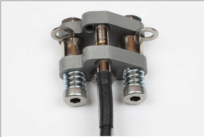
Abbildung 11: Dann wird der Hallsensor (zum Einstellen der Mindestkraft) justiert, wobei der Sensor mit etwa 1 mm vorgespannt sein sollte. Beim Erreichen der Mindestkraft leuchtet die Force (bzw. Start ) LED der CTS-Box auf.
