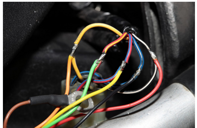
Abbildung 4: Anschluss des Kabelbaums (rechts neben der Airbox).
