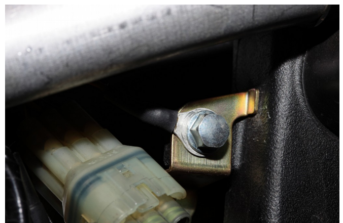
Abbildung 5: Masseanschluss des Kabelbaums.
