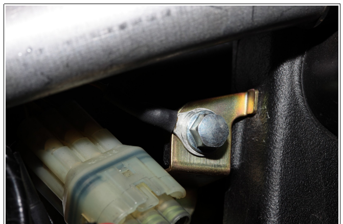
Abbildung 5: Masseanschluss des Kabelbaums.
