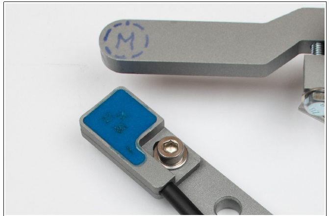
Abbildung 7: Das Sensorelement „Klauen sind teilweise im Eingriff“ spricht als erstes an (Fehlerhafte Anordnung).
