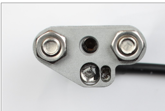
Abbildung 12: Hierbei ist zu beachten, dass das schwarze Hallsensorelement dem Magneten gegenüberliegt. Das Hallsensorelement ist das schwarze Teil in der vernickelten Sensorhülse. Der Magnet ist in der Magnetplatte eingeklebt.
