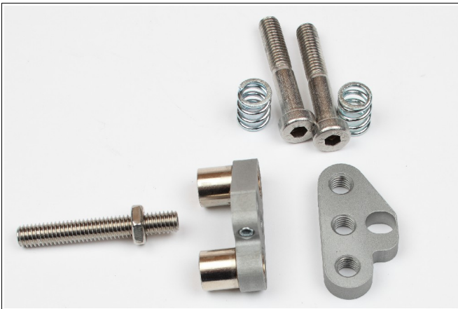
Abbildung 5: Die Inbus-Madenschraube M6x40 wird entfernt.
