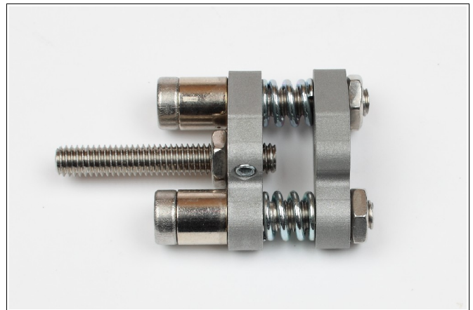
Abbildung 2: Als erstes wird der Hallsensor (mit Inbus-Schlüssel SW2) entfernt.
