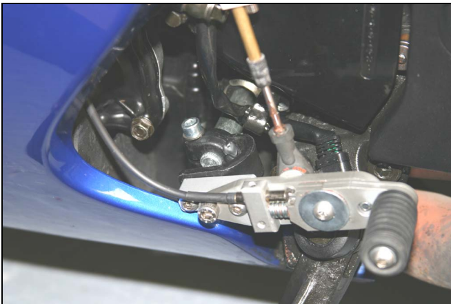
Abbildung 13: Honda CBX1100 mit Schalthebelsensor statt Kraftsensor (letzterer kann aufgrund des fehlenden Schaltgestänges nicht montiert werden).
